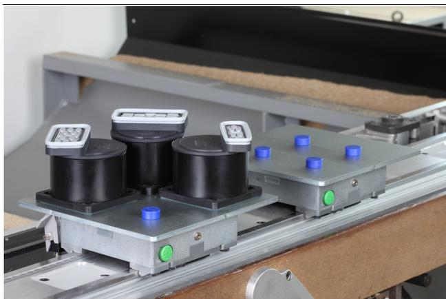
Plaques d'adaptation ISAP-B avec Mono-Base et blocs ventouses pour le bridage de pièces en bois
